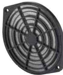
O filtro permite que o ar flua livremente com mínima resistência do ar. Com furos de montagem simples, são fáceis de instalar ou remover para manutenção e substituição. Inclui um protetor de dedo, filtro de espuma e retentor, feito com plástico de alto impacto UL94-V0. O filtro de espuma atende aos requisitos de geração de fumaça UL94HF1.
