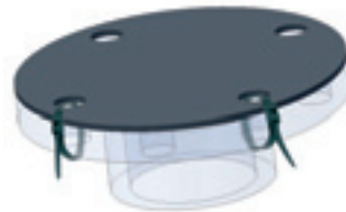
Abraçadeiras presas através de furos fixam o disco ao flange
